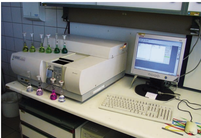
Abb. 28: Nitrit- und Ammoniumbestimmung im Labor mittels Spektralphotometers, © AGES
